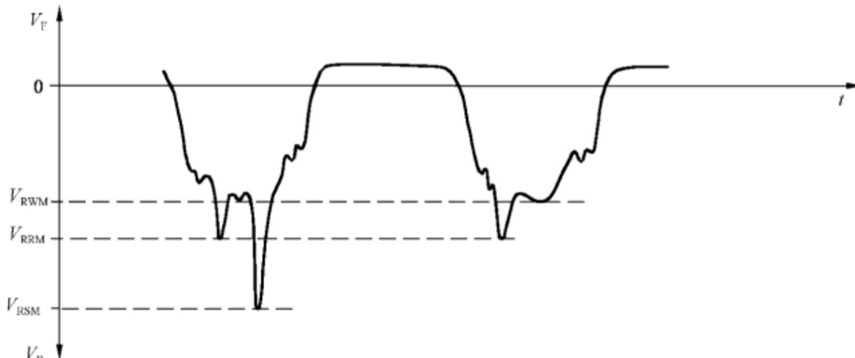
图 4 反向电压额定值
