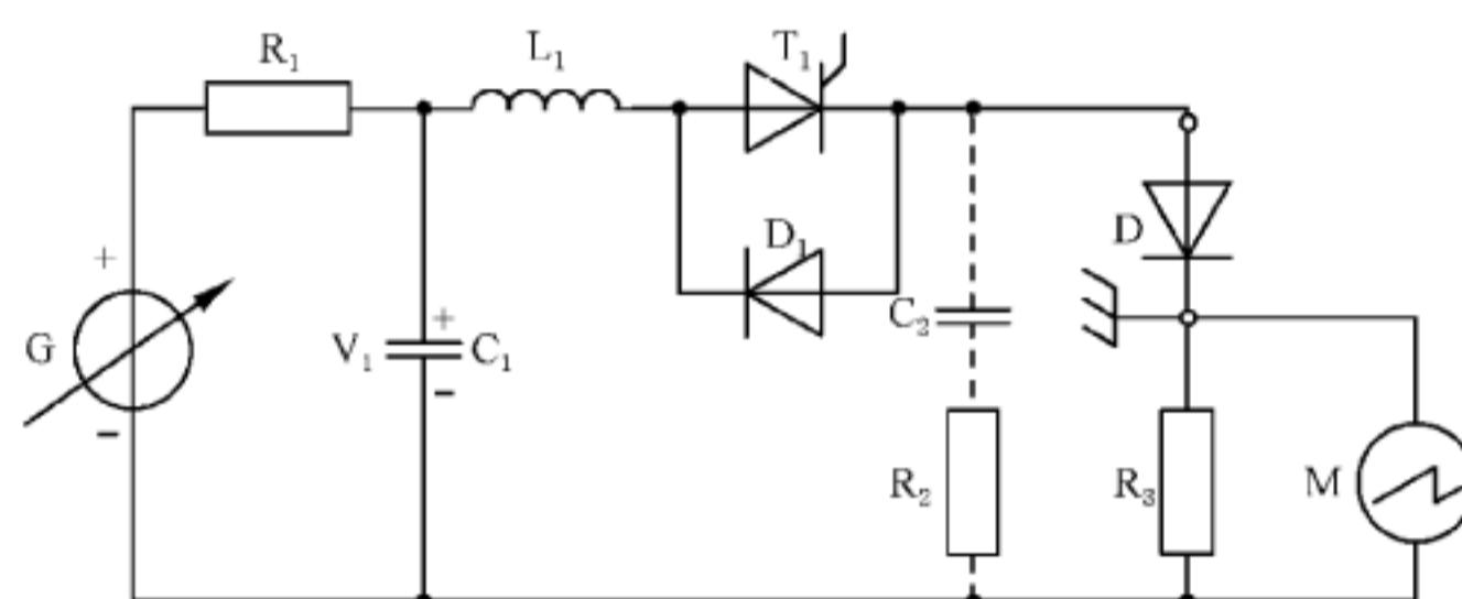
图 19  $Q_r$  和  $t_{rr}$  的测试电路(正弦半波法)
