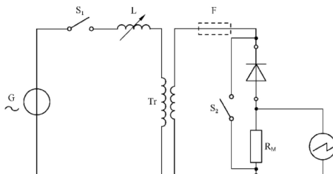
图 36 管壳不破裂峰值电流的测试电路
