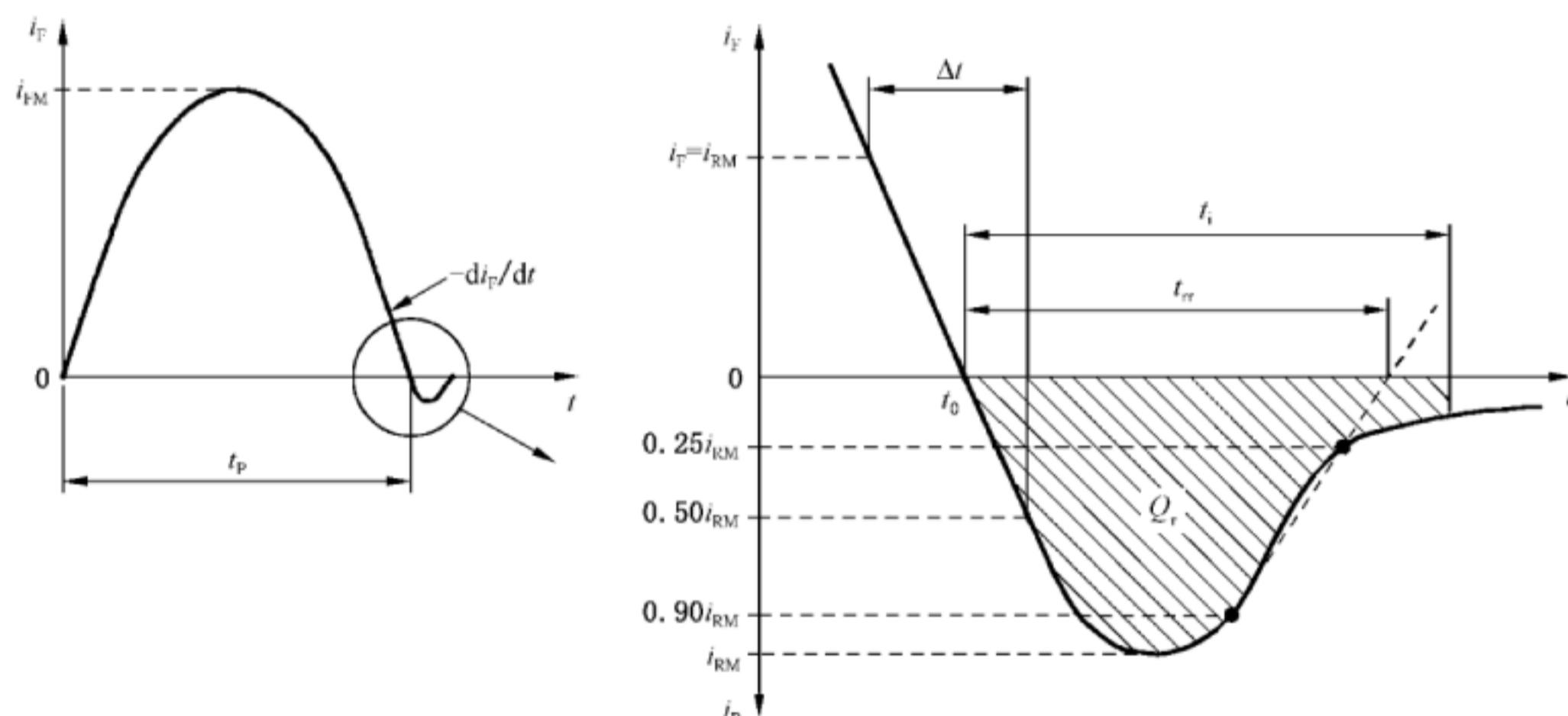
图 20 通过二极管 D 的电流波形(正弦半波法)
