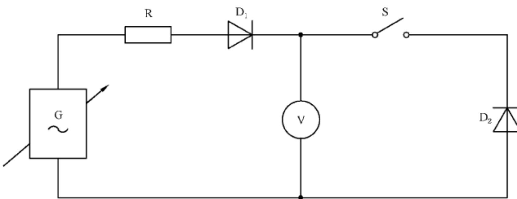
图 28 反向不重复峰值电压的测试电路
