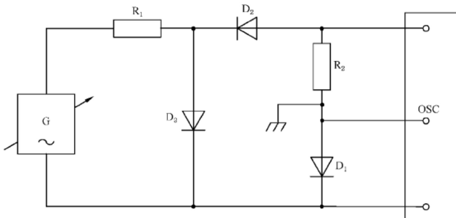
图 17 反向峰值电流的测试电路
