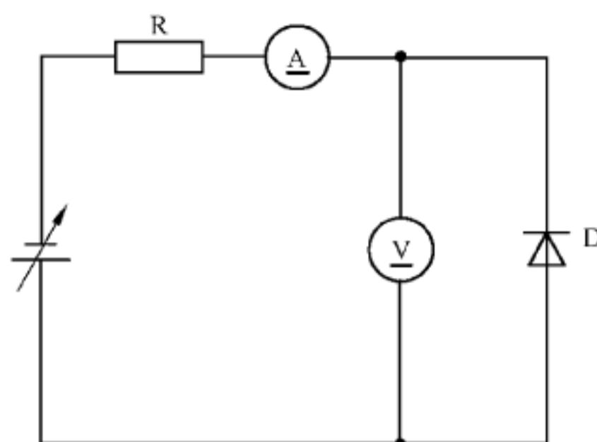
图 10 正向电压的测试电路(直流法)
