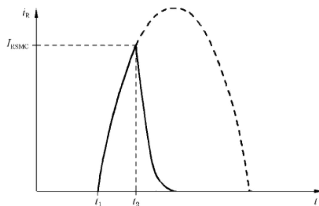
图 37 通过受试器件的反向电流  $i_R$  波形**电路说明和要求：**
