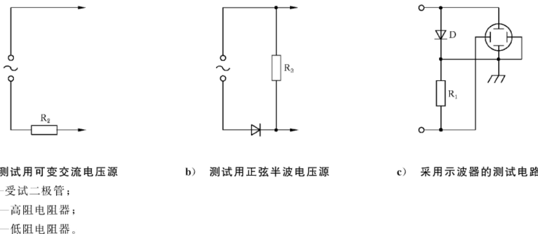
图 16 反向电流的测试电路(示波器法)
