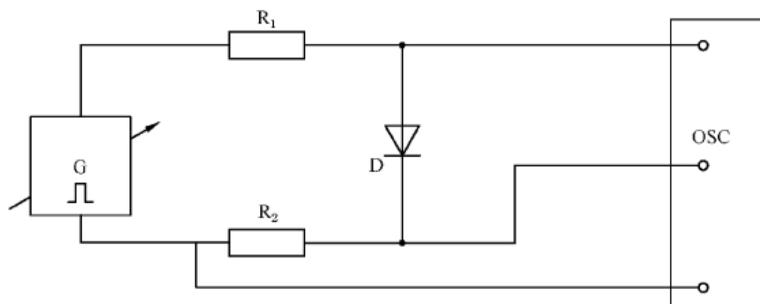
图 12 正向电压的测试电路(脉冲法)
