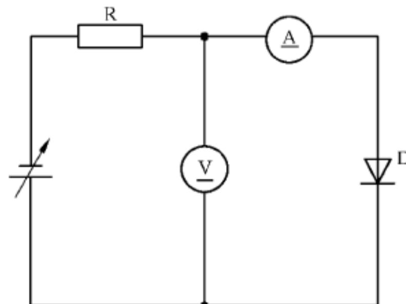
图 15 反向电流的测试电路(直流法)
