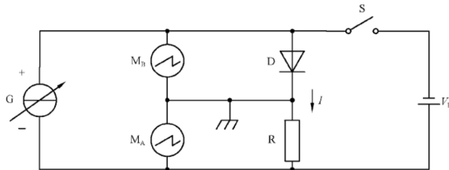
图 23  $t_{fr}$  和  $V_{FRM}$  的测试电路
