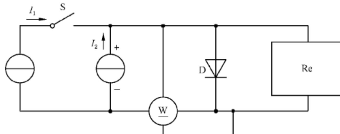
图 26 瞬态热阻抗的测试电路
