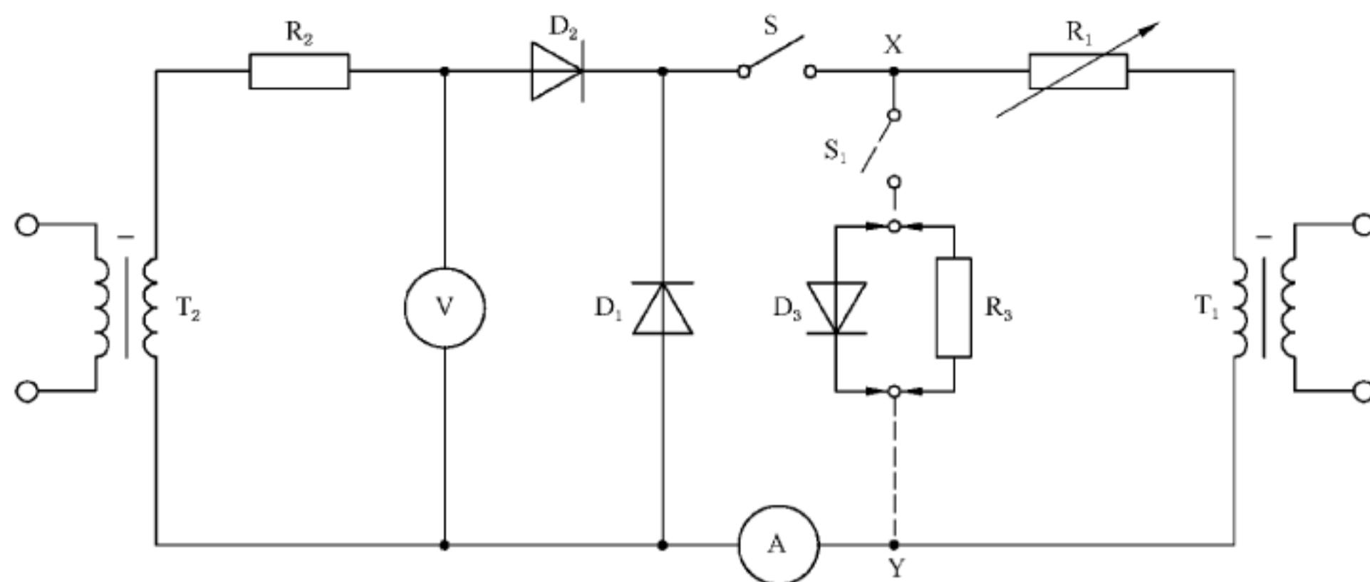
图 27 浪涌电流的测试电路
