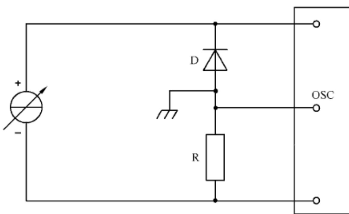
图 14 击穿电压的测试电路
